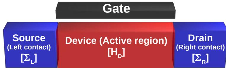
Figure 1: Modèle général du transistor à effet de champ avec un canal central connecté aux contacts de source et de drain et contrôlé par une grille.
