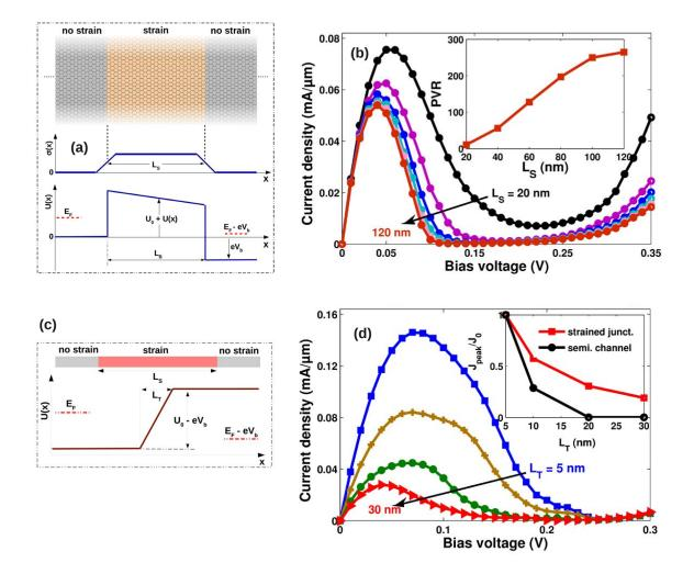
Figure 4: Représentation schématique des structures à simple barrière (a) et caractéristiques à I - V correspondantes calculées pour différentes longueurs  $L_S$  de la région contrainte (b). Structure des jonctions tunnel p-n (c) et caractéristiques I - Vcorrespondantes du dispositif pour différentes longueurs de transition  $L_T$  (d).
