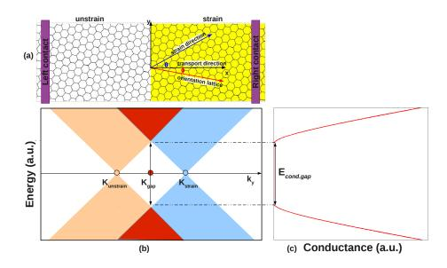
Figure 2: (a) Jonctions de graphène contraint/non-contraint. (b) Structure des bords de bandes illustrant le changement induit par déplacement des points Dirac le long de la direction  $k_y$  qui mène à l'ouverture d'un gap de conduction (c).
