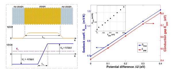
Figure 3: Vue schématique de la structure de graphène constituée d'une diode PN avec une zone contrainte localement (a) et coefficient Seebeck maximal (Smax) et gap de conduction  $(E_{gap})$  en fonction de  $\Delta U$  (b).
