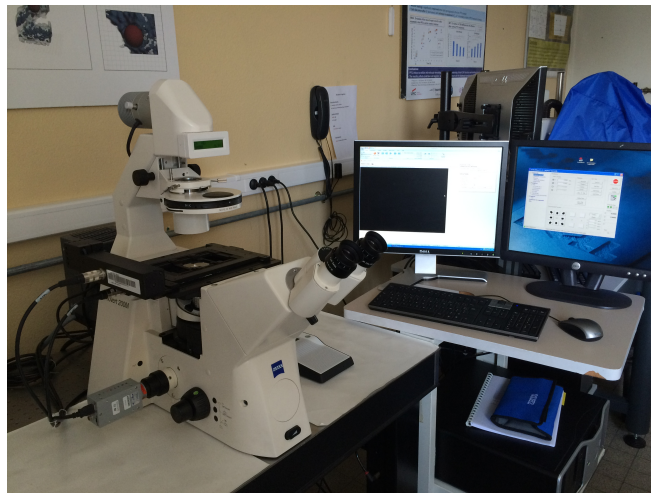
FIGURE 4.1 – Photo du banc de vidéo-microscopie à haute vitesse. Comprend le microscope, la platine motorisée, la caméra haute vitesse et l'ordinateur de contrôle.
