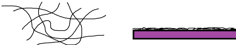
Figure 4 : Structure sol-gel obtenue à \text{pH} < 3 : gel polymérique linéaire.
