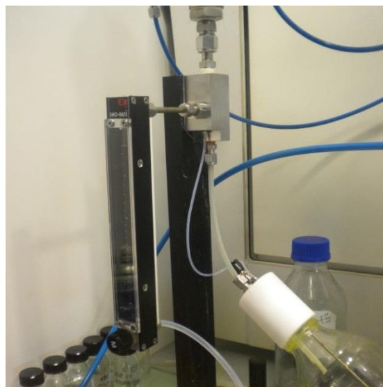
Figure 26: Photographie du débitmètre installé en amont de la buse de nébulisation pour contrôler le débit d'azote.
