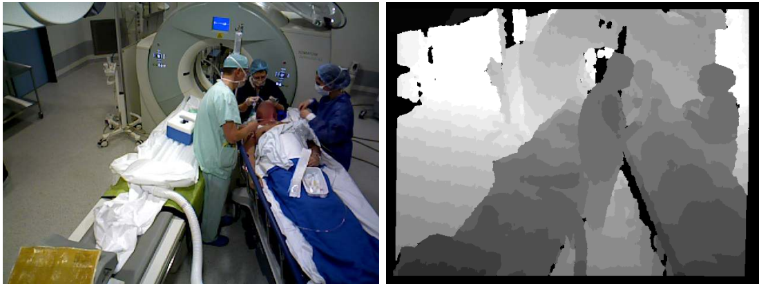
Figure B.3: Une paire d'images de couleur et de profondeur capturées à l'aide d'une caméra Asus Xtion Pro .
