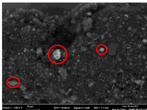
Zones claires riches en Co (cliché en électrons rétrodiffusés à un grandissement de 1000)
