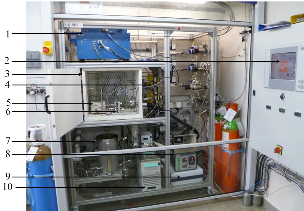
Figure 93 : Photographie de l'unité permettant d'effectuer la REC du CO 2 en phase gaz
