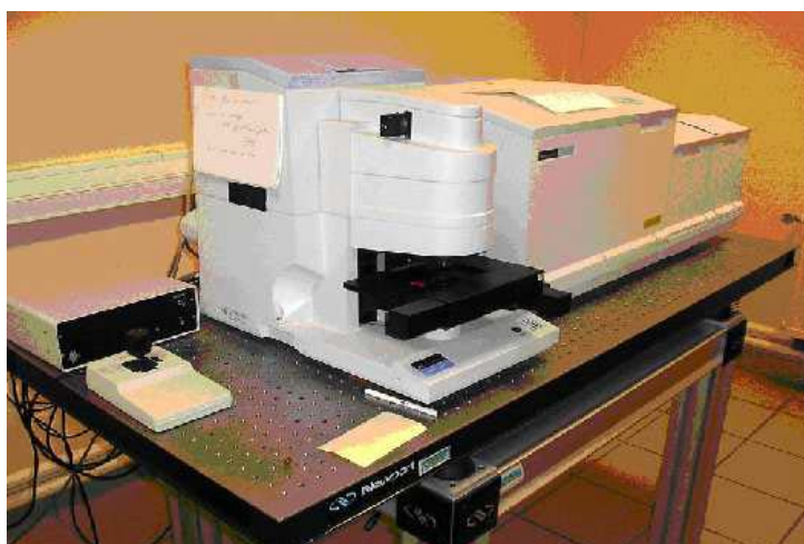
Figure II.10. Schéma du dispositif de spectromètre infrarouge à transformé de fourrier de marque "Bruker" modèle "Vertex 70 v".
