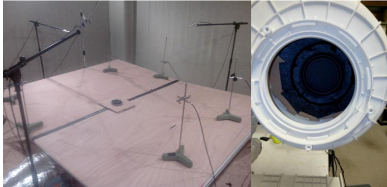
Figure 3-26 : Haut-Parleur bafflé libre (gauche) et haut-parleur placé au niveau du ventilateur dans la maquette Cesam (droite)
