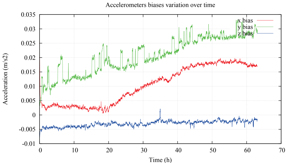
FIGURE 5.8 – Évolution des biais des accéléromètres pendant 63h, avec une période de moyennage de 100s. Ces valeurs sont elles-mêmes biaisées puisque l'orientation n'est pas précisément connue et la participation de la gravité n'a pas pu être éliminée correctement, mais les variations sont tout de même représentatives.
