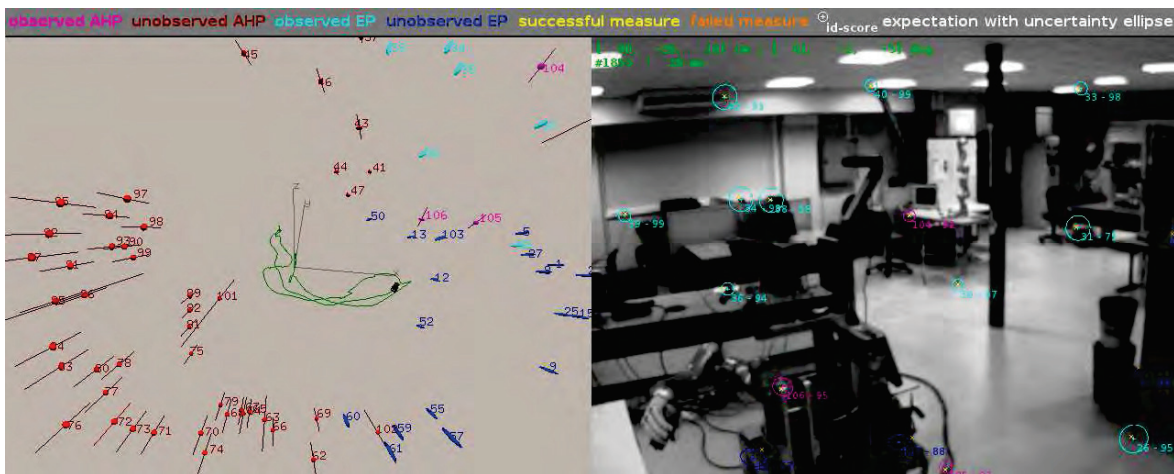
FIGURE 3.3 – Affichage 2D et 3D de RT-SLAM. Les couleurs dans les tons rouges et bleus représentent différentes paramétrisations d'amers, tandis que les couleurs brillantes contre celles plus foncées signalent que l'amer est couramment observé. Les segments illustrent l'incertitude de profondeur quand elle est grande.
