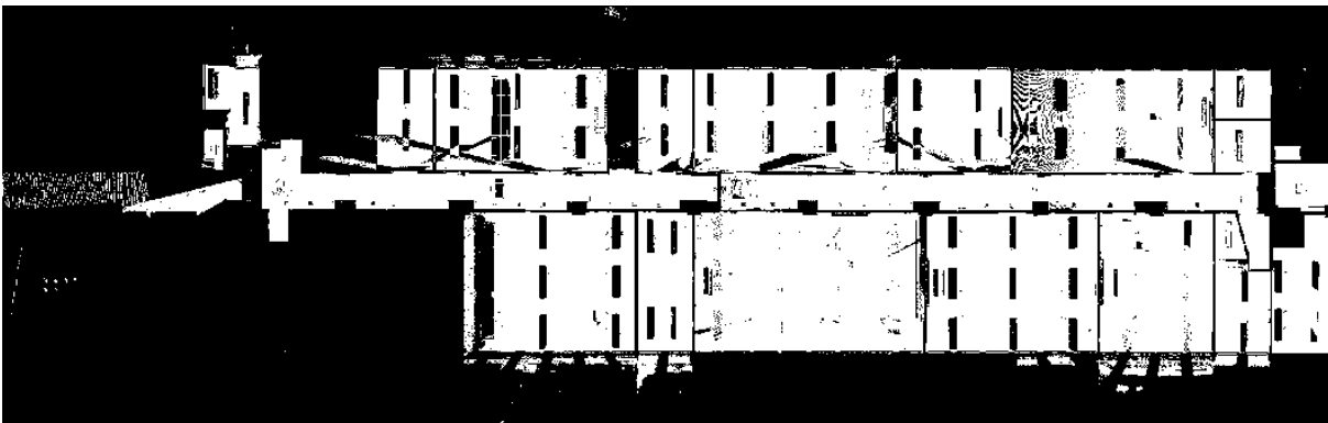
(a) Image binaire générée à partir du nuage couvrant les plafonds
