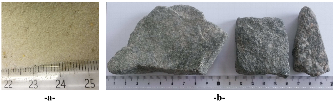
Figure 3.28: Types de sols utilisés, a) sable fin, b) granulats (ballast).
