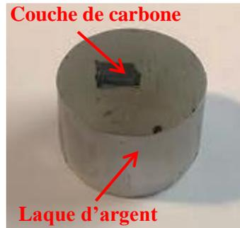
Figure.II-23 : échantillon métallisé à la laque d'argent
