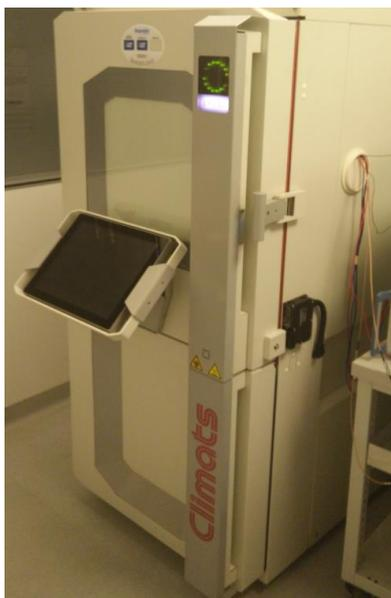
**Figure.II-2 : Enceinte climatique Climats Excal 1423-TE d'une seule chambre permettant de réaliser des essais de vieillissement passif de type VRT**
