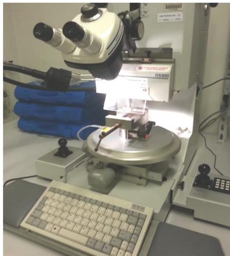
Figure.II-17 : Image de la machine de cisaillement Dage 4000
