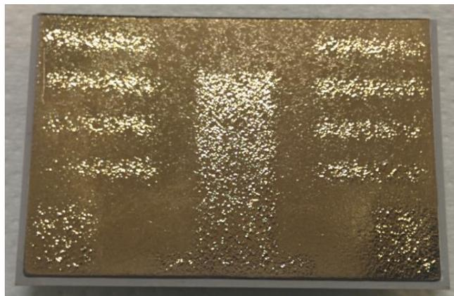
**Figure.IV-26 : Empreinte des motifs de la métallisation supérieure du substrat sur la métallisation inférieure**
