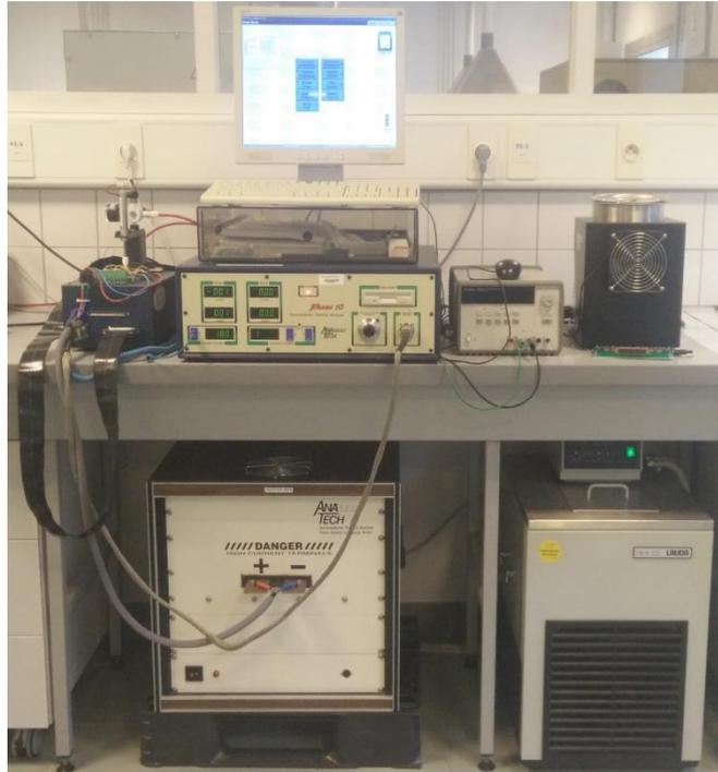
**Figure.II-7 : Photographie du banc de mesure de la résistance thermique (ANATECH PHASE 10) localisé au sein du laboratoire IMS**
