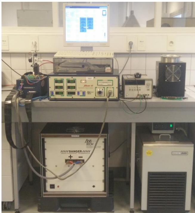
Figure.II-7 : Photographie du banc de mesure de la résistance thermique (ANATECH PHASE 10) localisé au sein du laboratoire IMS
