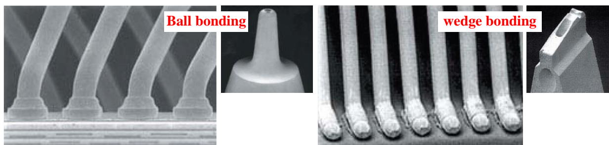
Figure.I-13 : Type de câblage filaire et tête du capillaire associé
