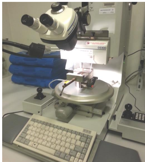
Figure.II-17 : Image de la machine de cisaillement Dage 4000
