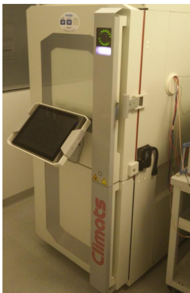
Figure.II-2 : Enceinte climatique Climats Excal 1423-TE d'une seule chambre permettant de réaliser des essais de vieillissement passif de type VRT
