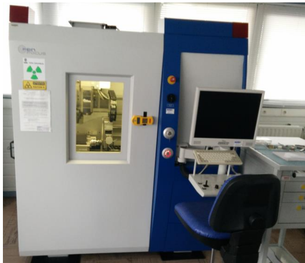
Figure.II-12 : Machine de Rayon X « Fein Fox » présente au sein du laboratoire IMS
