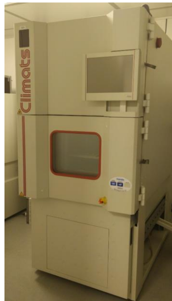
Figure.II-4 : Enceinte climatique Climats Série CTr bi-chambre permettant de réaliser des essais de vieillissement passif de type CHOC
