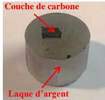
Figure.II-23 : échantillon métallisé à la laque d'argent
