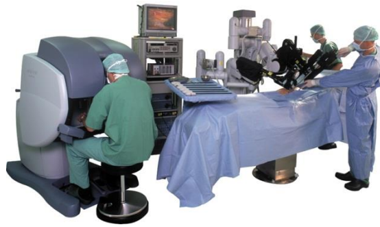
Figure 7 : robot Da Vinci® utilisé dans la chirurgie du cancer de la prostate 8
