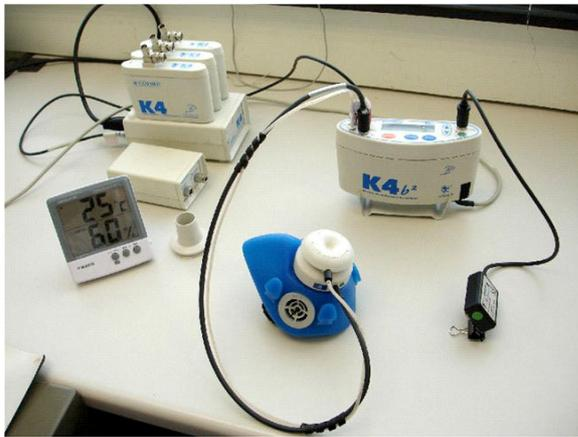
**Figure 1 :** Appareil de mesure d'échange gazeux, le K4b<sup>2</sup>.
