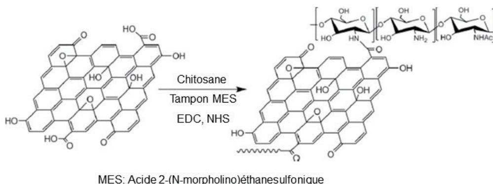
**Figure IV.15.** Fonctionnalisation du GO par le chitosane en présence des réactifs NHS et EDC [199].
