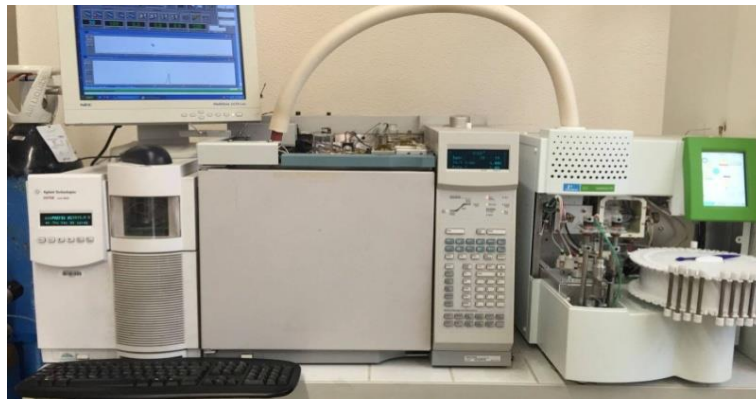
Figure 19. Schématisation du dispositif d'analyse des COV TDS-GC-MS/FID (Duncanu 2012) en haut et photographie du dispositif TD-350-GC-MS/FID en bas.
