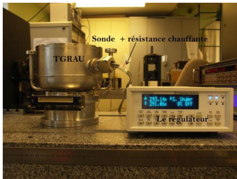
Figure 88 : photographie représentant le cryostat grande autonomie relié au régulateur.
