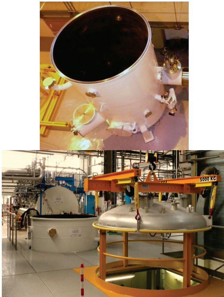
Figure II.6 Cryostat Multi Test dans le bâtiment 10.01 avec la platine d'HELIOS nue (à droite)
