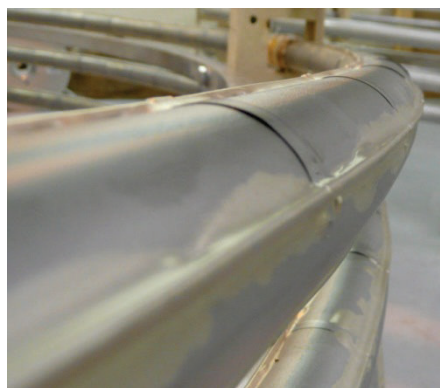
Figure II.12 Chauffages Thermocoax brasés sur les serpentins de la boucle
