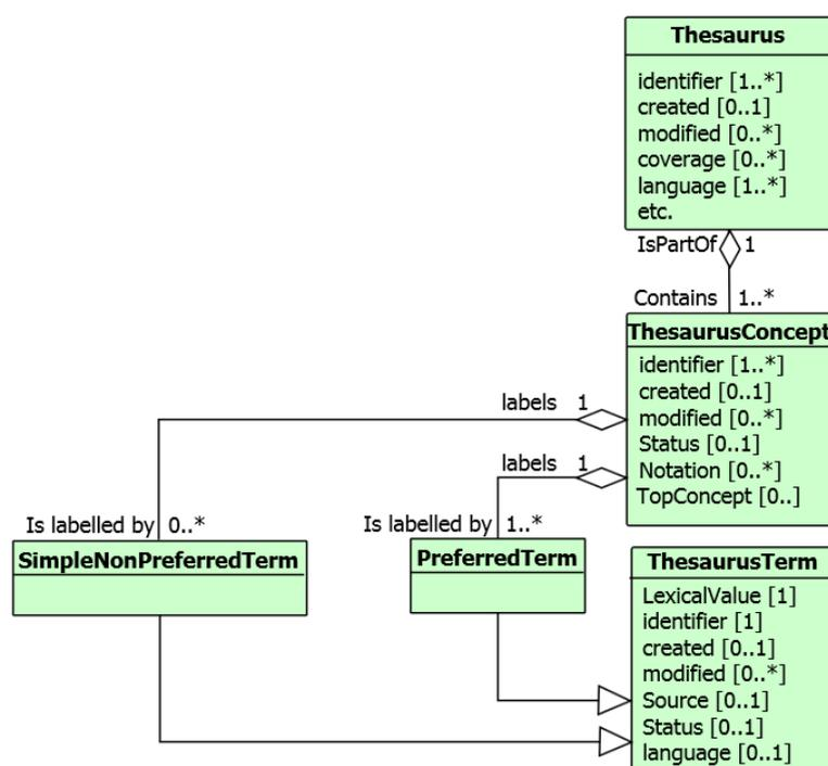
FIGURE 2.7 – Extrait du modèle UML fruit des travaux sur la norme BS8723 [?]
