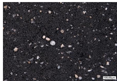
Figure 11 : Images MEB (première ligne) et MO (seconde ligne) de particules de Suglet® passées dans le procédé à 100 rpm, pour des essais d'enrobage à 100 rpm.
