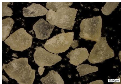
Figure 4 : Images MEB (première ligne) et MO (seconde ligne) de particules de semoule passées dans le procédé à 100rpm, pour des essais d'enrobage à 100 et 200 rpm.
