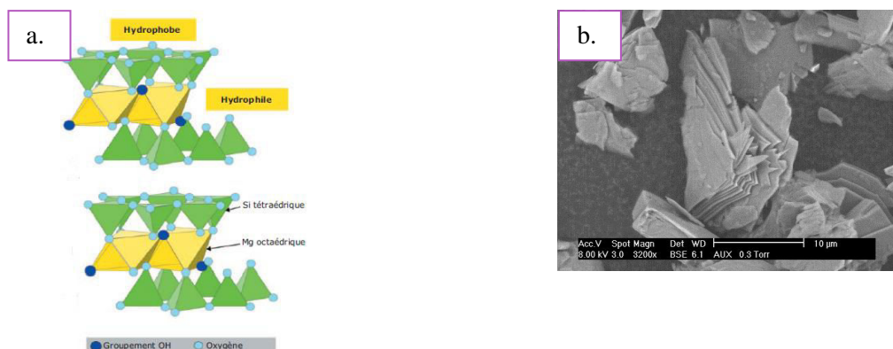
Figure 22 : a. Structure cristallographique du talc (Martin, 2008). b. Photographie MEB du Talc00 Luzenac à fort grossissement
