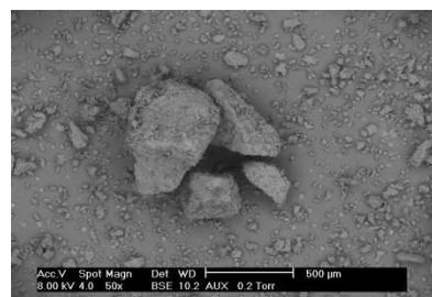
Figure 6 : Images MEB de particules de semoule passées dans le procédé à 100rpm, pour des essais d'enrobage à 100 et 200 rpm.
