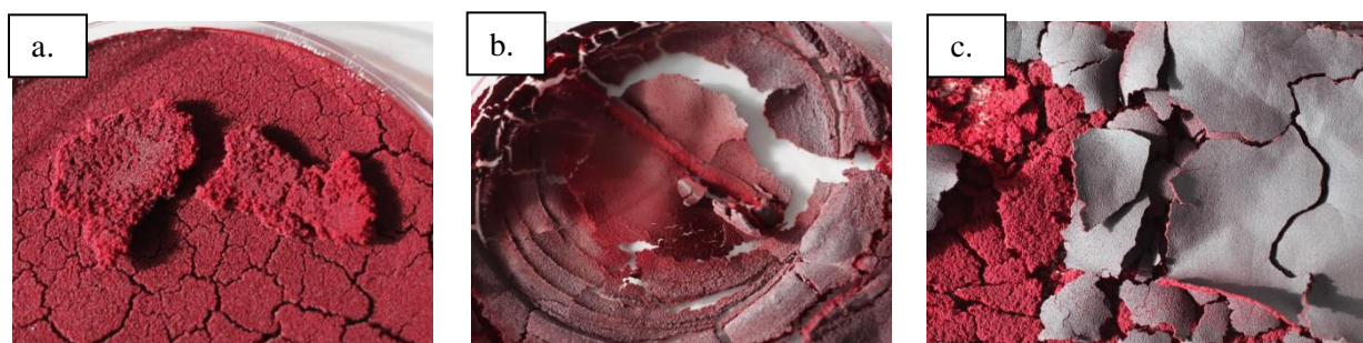
Figure 1 : Photographies d'observation des différentes méthodes de séchage a. Séchage sous hotte aspirante. b. Séchage sous hotte aspirante avec agitation continue. c. Séchage dans une étuve à 30°C
