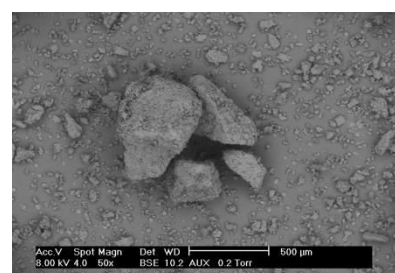
Figure 6 : Images MEB de particules de semoule passées dans le procédé à 100rpm, pour des essais d'enrobage à 100 et 200 rpm.
