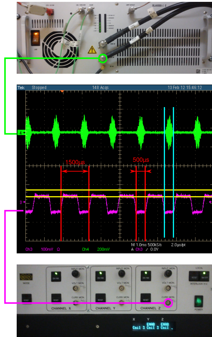
Fig. 3.4. Capture d'écran d'un oscilloscope connecté à un IRM Bruker Biospec 7T pendant le marquage dans une séquence pCASL. La durée d'une impulsion est de 500 \mu\text{s} elle est répétée tous les 1500 \mu\text{s} . Le signe du gradient selon z (courbe rose) est inversé à l'affichage. Les lignes jaunes désignent la valeur minimale des gradients pendant une expérience control (ligne du haut) et pendant une expérience label (ligne jaune du bas). La courbe verte correspond aux impulsions RF.
