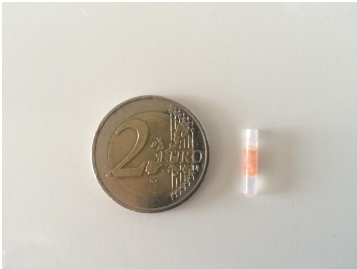
FIGURE 3.3 – Dispositif HRMAS nécessaire à la préparation des échantillons biologiques. Insert jetable de 30 \mu\text{L} contenant une biopsie ainsi que son bouchon.
