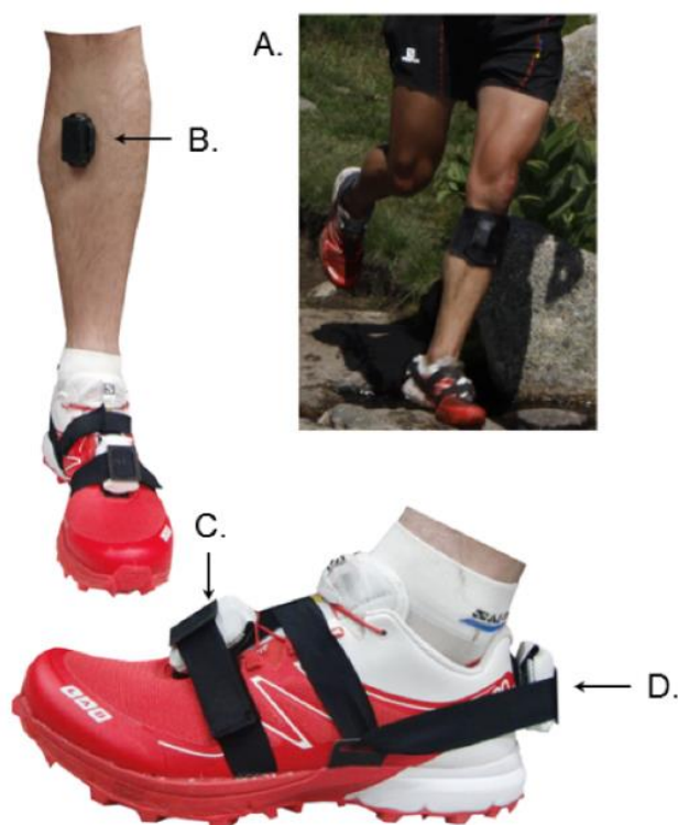
Figure 20. Placement des trois accéléromètres. (A) Placement des accéléromètres lors de la course. (B) Placement de l'accéléromètre du tibia permettant de quantifier la sévérité de l'impact au cours de la course. (C et D) Placement et fixation des accéléromètres du talon et des métatarses permettant l'identification de la pose de pied au cours de la course.
