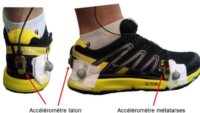
Figure 17. Placement des marqueurs réfléchissants et des accéléromètres.
