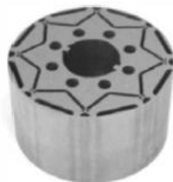
Figure I.8 : Rotor du moteur PMSM installé dans une Nissan Leaf [42]
