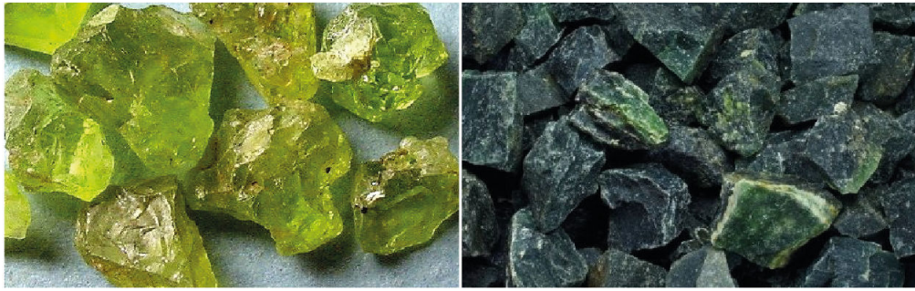
FIGURE 2.1 – Photographie de fragments d'olivine de San Carlos et d'antigorite (~ cm).
