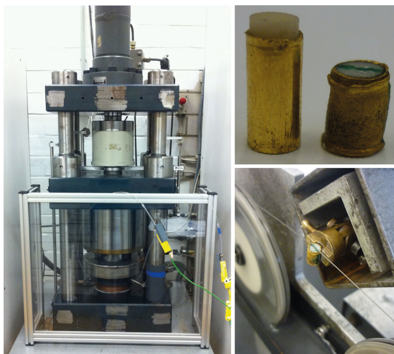
FIGURE 4.2 – Presse Griggs , Ruhr Universität Bochum (à gauche) ; échantillon non-déformé dans sa capsule en or et échantillon déformé (en haut à droite) ; sciage de l'échantillon avec une scie à fil (en bas à droite).
