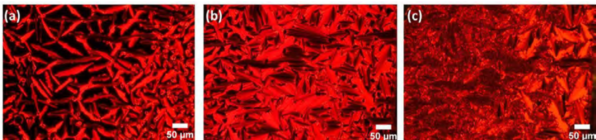
Figure 21 : images (650 x 490 μm) en microscopie optique polarisée en polariseurs croisés de CAO (a) à 180°C, (b) à 170°C et (c) à 85°C
