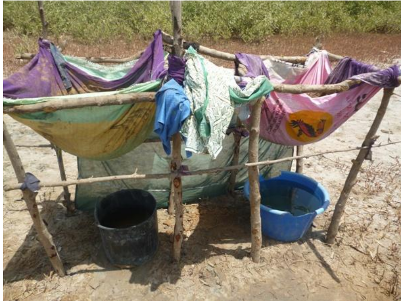
Photo 21 : Technique de recueil de l'eau filtrée après le mélange avec les croûtes de sel à Colobane/Ziguinchor
