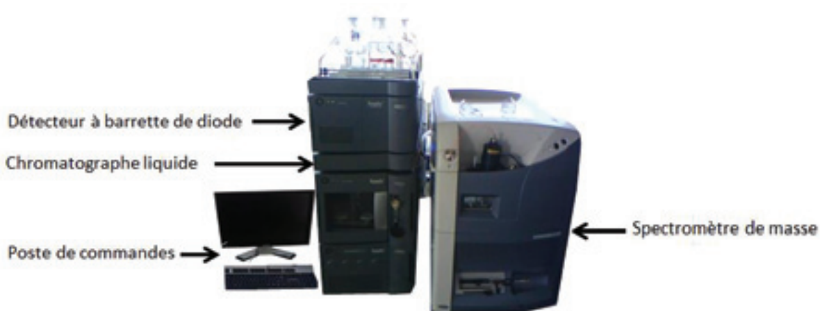
Figure 2 : Chromatographe liquide Ultra Performance (UPLC) Waters Quattro couplé à un spectromètre de masse triple quadrupole et son poste de commandes.
