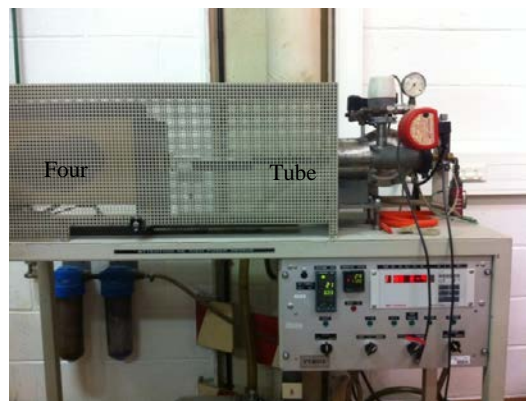
Figure 3.3 : Four haute température sous vide secondaire utilisé pour tester les pointes d'indentation
