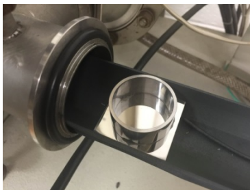
Le contre-matériau dans le demi-tube
