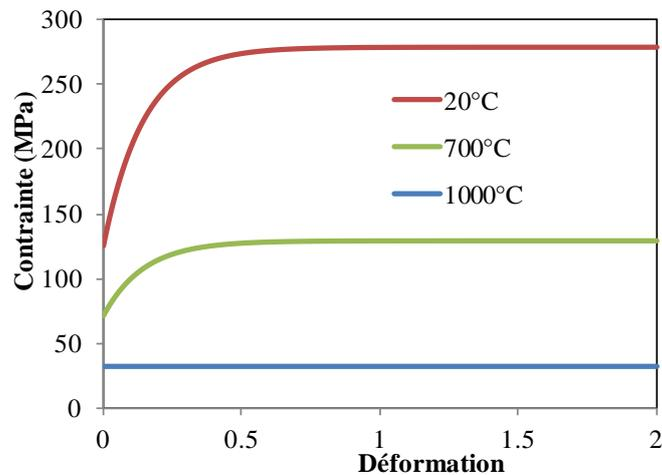
Figure 2.2 : Courbes d'érouissage du 316L aux différentes températures
