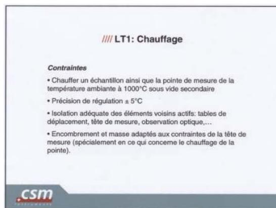
Figure 2.26 : Spécifications pour la température de chauffage
