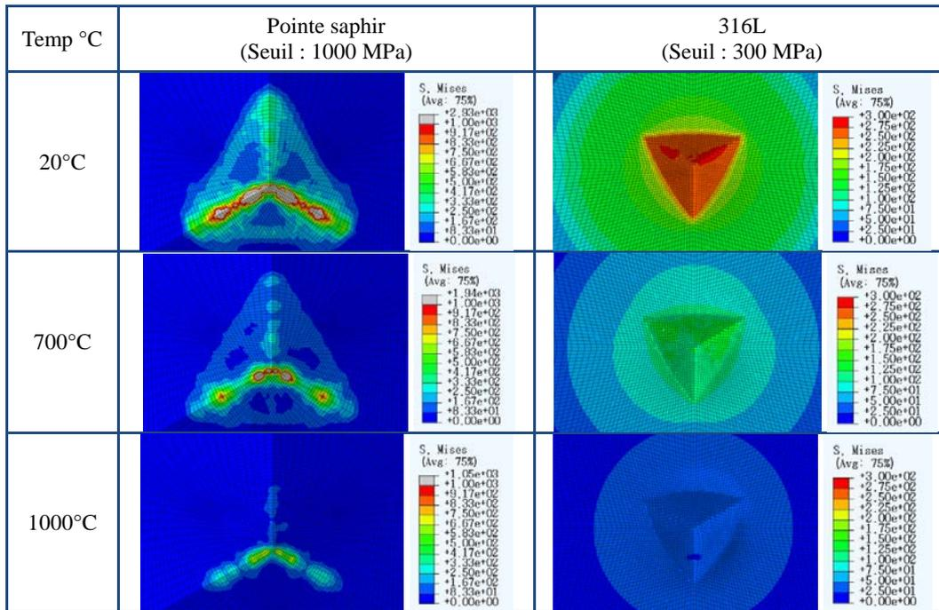
Figure 2.17 : Distribution de la contrainte de von Mises dans une pointe en saphir et dans le contre matériau lors de l'indentation de l'acier 316L pour une pénétration de  $20\mu\text{m}$
