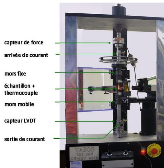
Figure 1.3 : Machine de traction à chaud [19]
