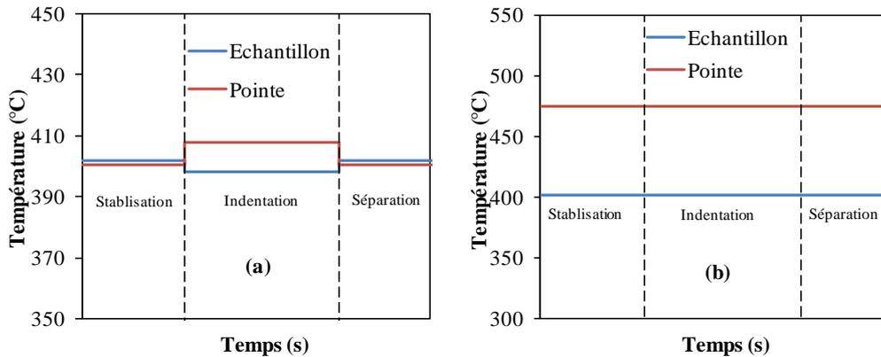
Figure 4.11 : Evolutions temporelles de la température de la pointe et celle de l'échantillon
