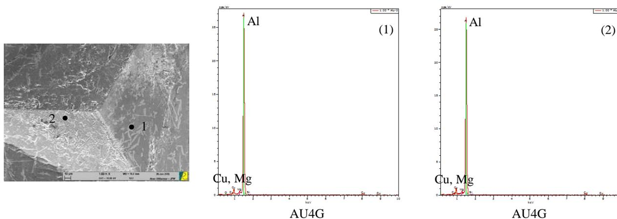
Figure 3.37 : Analyse EDX du contre-matériau en aluminium après l'essai à 500°C
