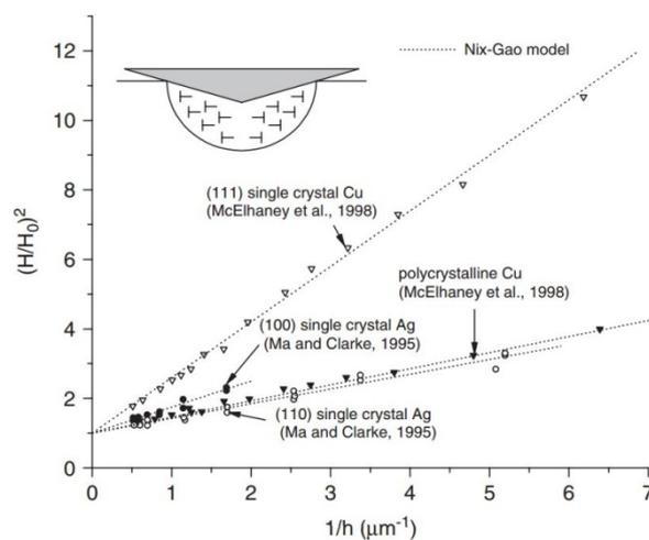
Figure 1.19 : Correspondance entre la relation du modèle de Nix et Gao et les données de dureté de micro-indentation pour les cuivres et l'argent [114]
