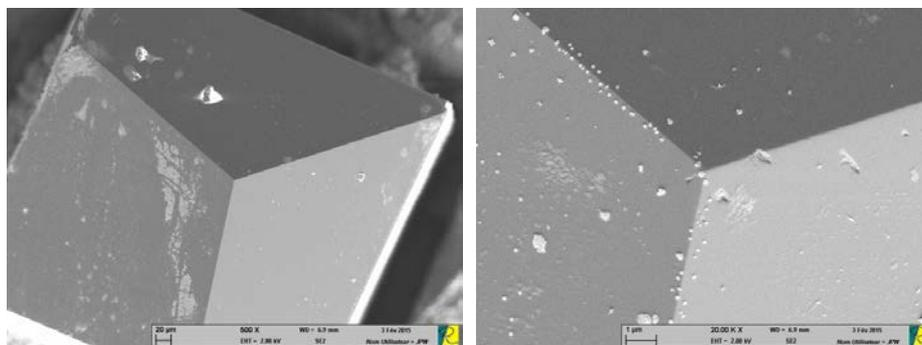
Figure 3.38 : Microscopies de la pointe après le nettoyage par ultrason
