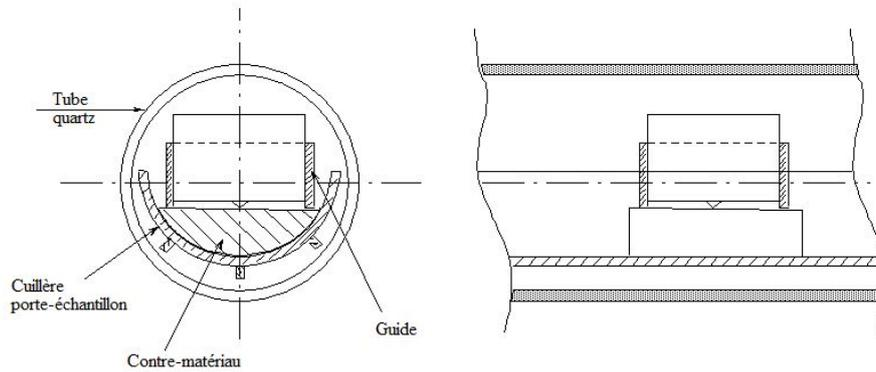
Figure 3.2 : Représentation schématique du dispositif d'essai
