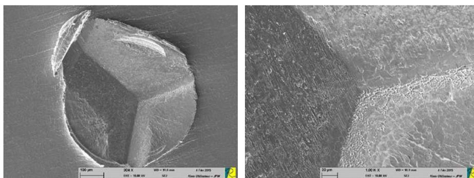
Figure 3.40 : Empreinte sur le contre-matériau en aluminium après le deuxième essai à 500°C
