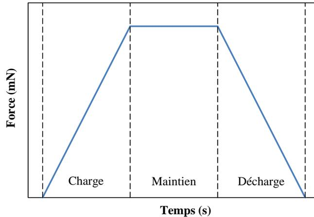
Figure 4.22 : Essai normal d'indentation en force contrôlée
