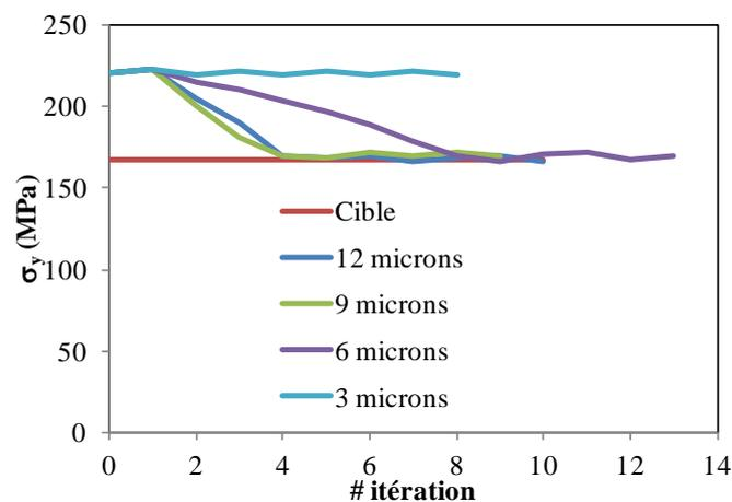
Figure 2.30 : Convergence de l'identification inverse pour différentes profondeurs d'indentation
