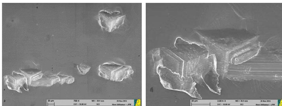
Figure 3.28 : Empreintes observées sur le contre-matériau en Waspaloy après l’essai à 600°C
