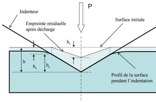
Figure 1.12 : Description de la géométrie d'indentation utilisée dans l'analyse Oliver et Pharr [76, 77]
