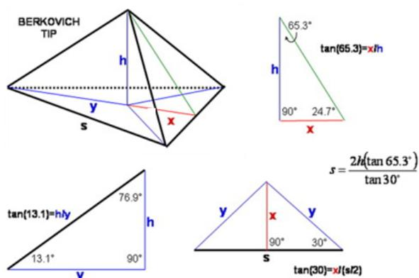
Figure 2.11 : Géométrie standard d'une pointe de type Berkovich
