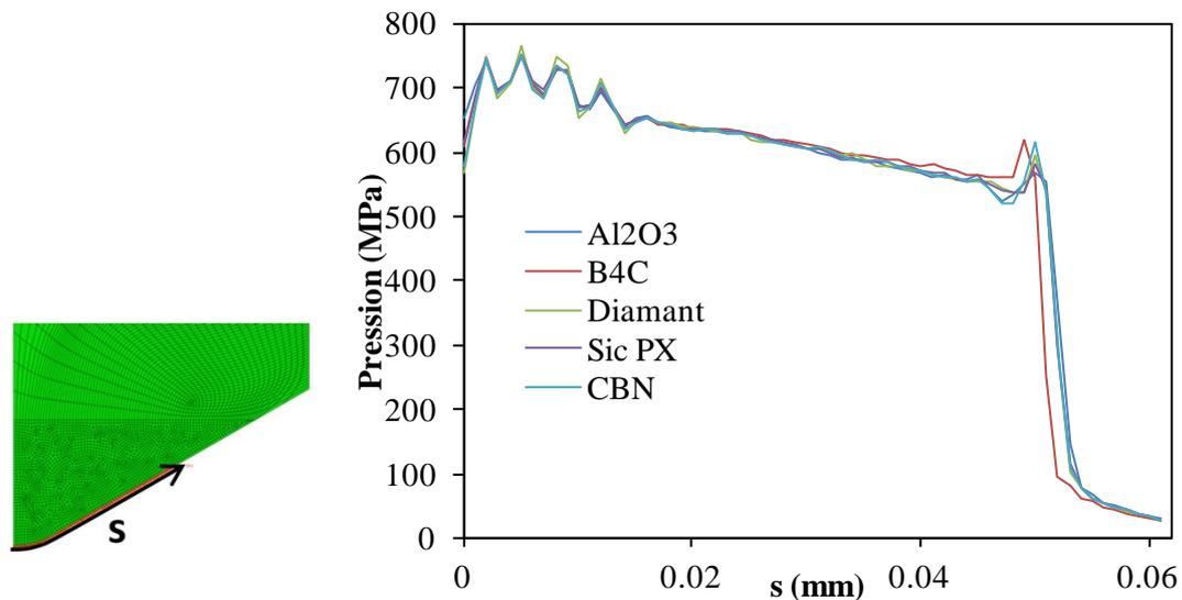
Figure 2.8 : Evolution de la pression de contact le long de la pointe lors de l'indentation de l'acier 316L à 20°C et à l'aide de différentes pointes coniques
