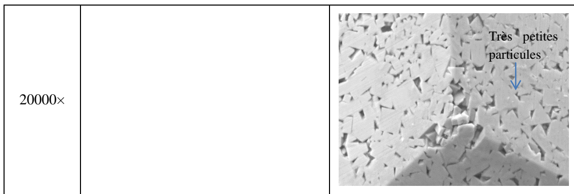
Figure 3.24 : Observations MEB de la pointe en WC avant et après le nettoyage par ultrason
