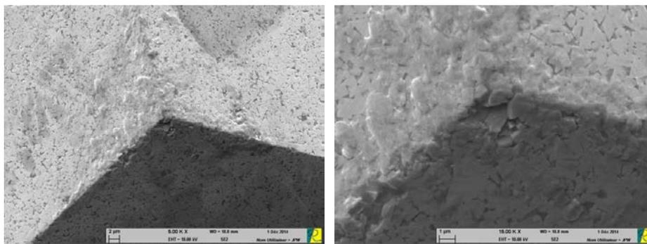
Figure 3.30 : Observations MEB de la pointe en WC après le nettoyage par ultrason
