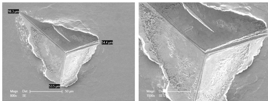
Figure 3.13 : Empreinte sur le contre-matériau en acier 316L après l'essai à 600°C
