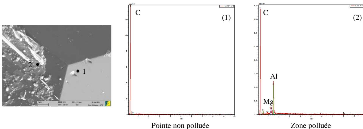
Figure 3.36 : Analyse EDX de la pointe en diamant après l'essai à 500°C
