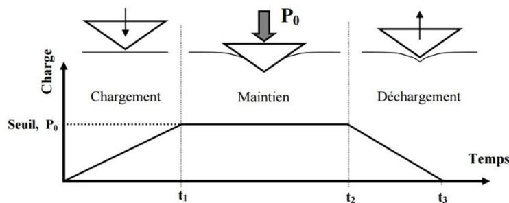
Figure 4.7 : Description d'un essai d'indentation à force imposée [149]
