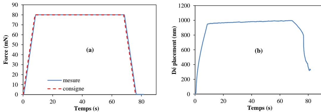
Figure 4.8 : Mesures lors d'un essai à force contrôlée à la température ambiante :
