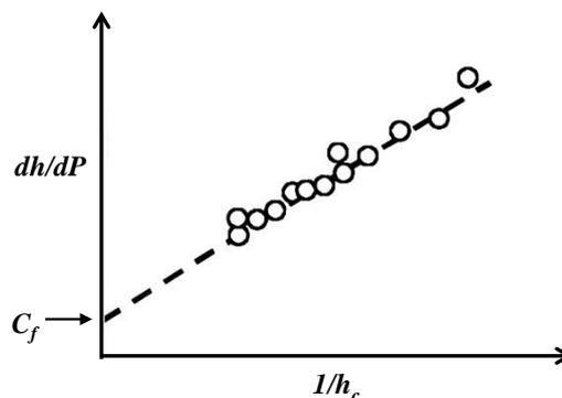
Figure 1.21 : Détermination expérimentale de la souplesse de l'appareil [93]
