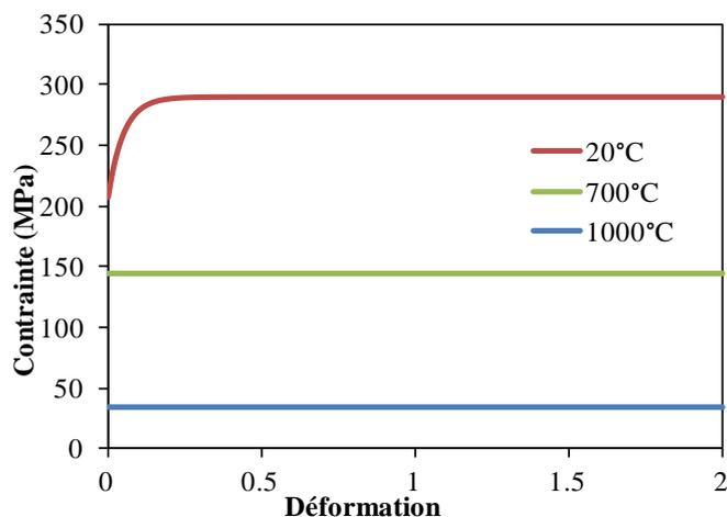
Figure 2.3 : Courbes d'écrouissage de l'Inconel 82 aux différentes températures
