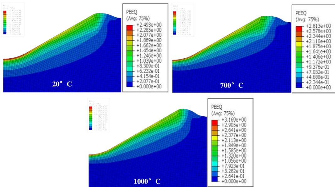
Figure 2.10 : Contours de la déformation plastique équivalente pour différentes températures lors de l'indentation de l'acier 316L
