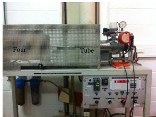
Figure 3.3 : Four haute température sous vide secondaire utilisé pour tester les pointes d'indentation
