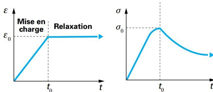
Figure 1.6 : Représentation schématique d'un essai de relaxation typique [24]
