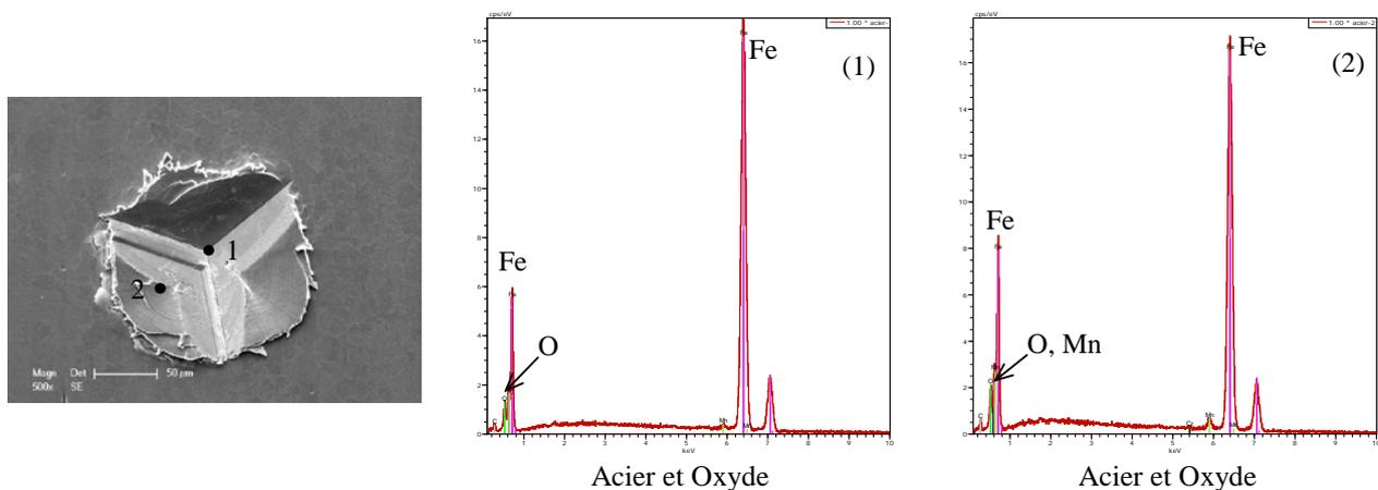
Figure 3.19 : Analyse EDX du contre-matériau en acier 316L après le second essai
