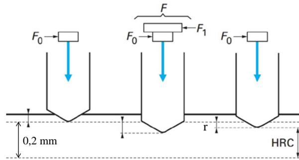
Figure 1.8 : Description d'un essai de dureté Rockwell [27]
