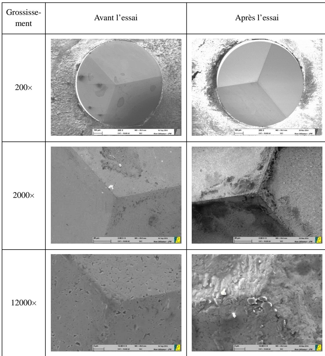
Figure 3.26 : Observations MEB de la pointe en WC avant et après l'essai à 600°C
