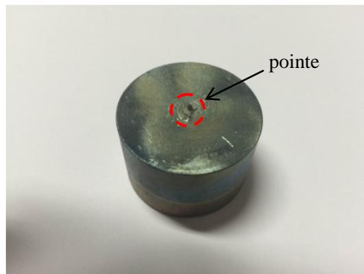
Figure 3.6 : La pointe en WC collée sur le cylindre servant de poids mort
