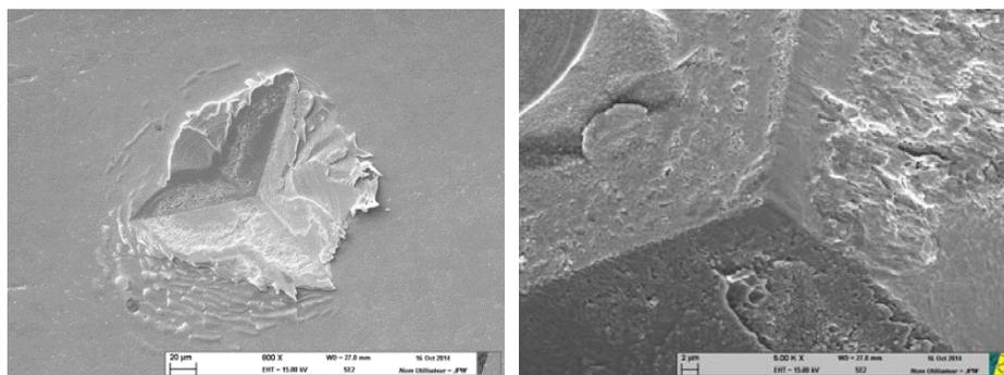
Figure 3.21 : Empreinte observée sur le contre-matériau en acier 316L après l’essai à 600°C
