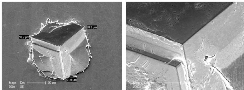
Figure 3.18 : Empreinte sur le contre-matériau en acier 316L après le second essai à 600°C
