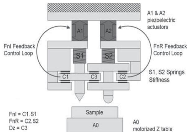
Figure 4.4 : Schéma de principe de nano-indenteur Anton Paar
