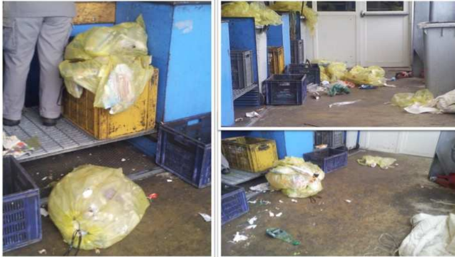
Figure 25 : trois exemples de sacs de collecte non ouverts par les machines et mis de côté par les opérateurs de tri (CDT2)
