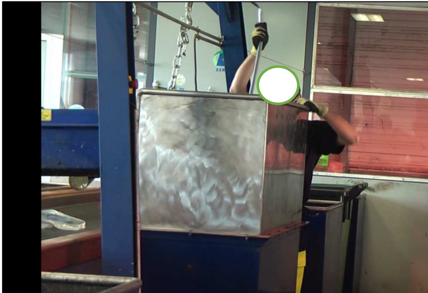
Figure 58 : photographie d'un opérateur utilisant une "perche" pour débourrer la presse à paquets
