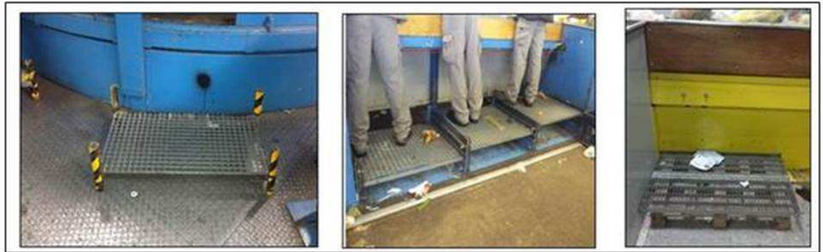
Figure 7 : différents types de rehausseurs pour les postes de tri (respectivement CDTE, CDT2 et CDT4)
