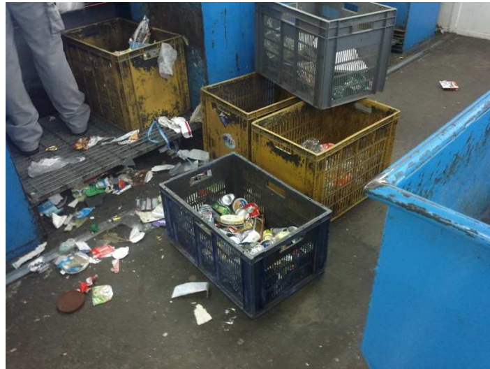
Figure 22 : exutoires mobiles superposés pour limiter l'encombrement de l'espace dans la cabine de tri (CDT2)
