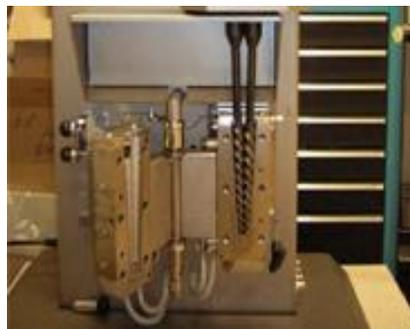
Figure 39 : Photo du micro-compounder bi-vis DSM micro 15.
