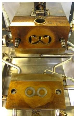
Figure 35 : Photo du mélangeur interne Thermo-Haake Rheomix 600 utilisé.
