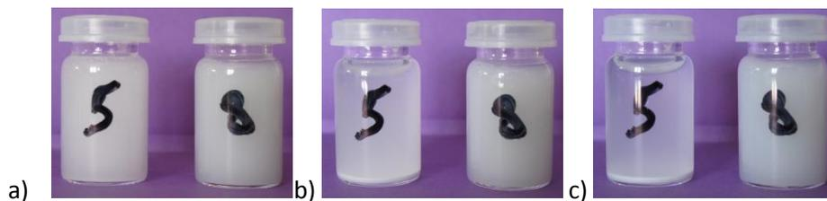
Figure 46 : Evolution des suspensions de CW<sub>L</sub>N(NaOH)I (5) et CW<sub>L</sub>USN(NaOH)IUS (8) pour des temps a) t=0, b) t=1h et c) t=8h.
