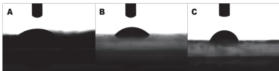
Fig. 4.9. Images d'angles de contact pour (A) MgAl, (B) BMAE et (C) BMAC HDL.
