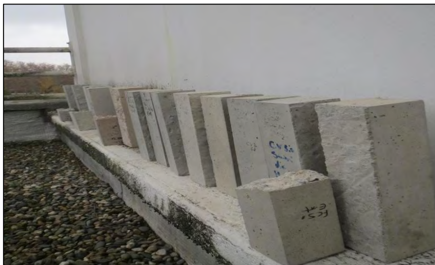
Figure II. 20 : Éprouvettes 7×7×28 cm en cours de carbonatation en conditions naturelles non - contrôlées à l'extérieur.
