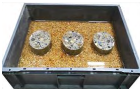
Figure II. 13 : Bac contenant de l'eau et des gravillons pour l'essai d'absorption par capillarité.
