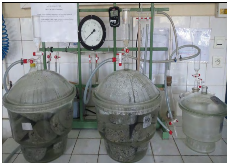
Figure II. 5 : Dispositif expérimental de porosité accessible à l'eau sur échantillons de béton durcis au LMDC.
