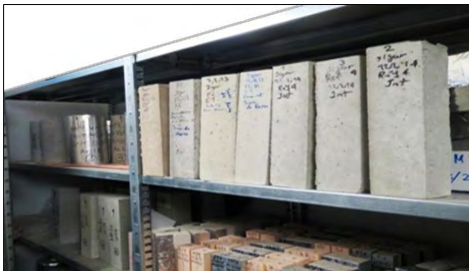
Figure II. 19 : Éprouvettes 7×7×28 cm en cours de carbonatation en conditions naturelles contrôlées en laboratoire.
