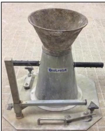
Figure II. 3 : Cône d'Abrams
