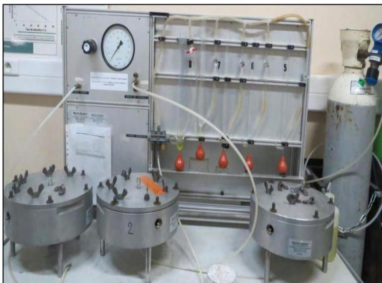
Figure II. 6 : Perméamétrie Cembureau au LMDC.
