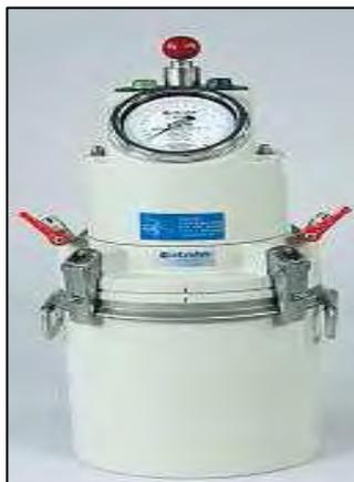
Figure II. 4 : Dispositif expérimental de l'aéromètre à béton
