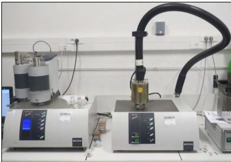
**Figure II. 10 : L'analyse thermogravimétrique au LMDC.**
