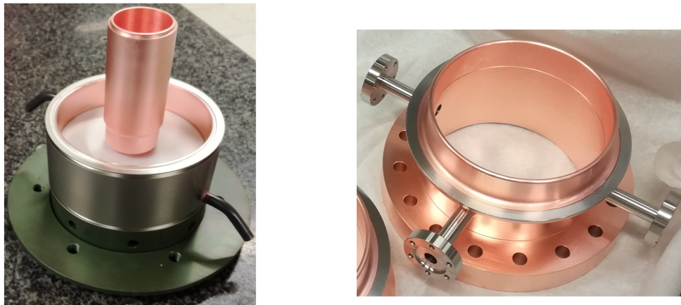
FIGURE IV.50 – Photographies de la fenêtre niveau 2 et d'un conducteur externe aval.
