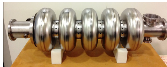
FIGURE I.17 – Photographie d'une cavité elliptique 5 cellules [CEA SACLAY]
