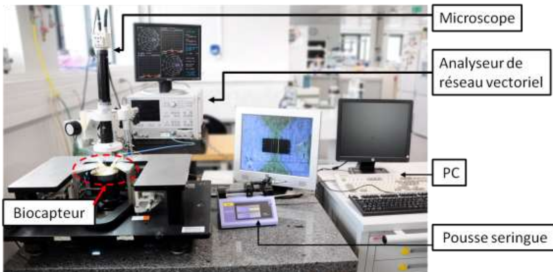
Figure II. 4 Banc de test biocapteur microfluidique
