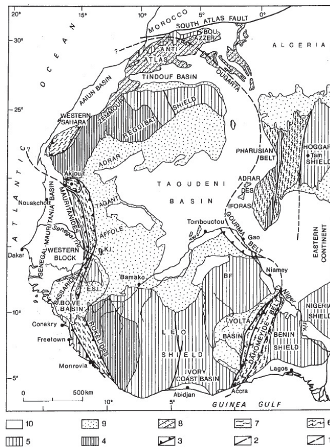
Figure 2-5 Eléments structuraux majeurs précambriens et paléozoïques de l'Afrique de l'Ouest. (1) limite du craton Ouest Africain, (2) Faille, (3) Chevauchement, (4) Socle Archéen Supérieur, (5) Socle Protérozoïque Inférieur, (6) Orogenèse Panafricaine, (7) Orogenèse Paléozoïque Supérieur, (8) Couverture Protérozoïque Supérieur-Paléozoïque Supérieur plissée, (9) Couverture Protérozoïque Supérieur-Paléozoïque Supérieur, (10) Couverture Post-Paléozoïque. ESI : Eastern Senegal inlier, KI : Kayes inlier, BF : Burkina Faso, Tam : Tamanrasset (Roussel et Lesquer, 1991).
