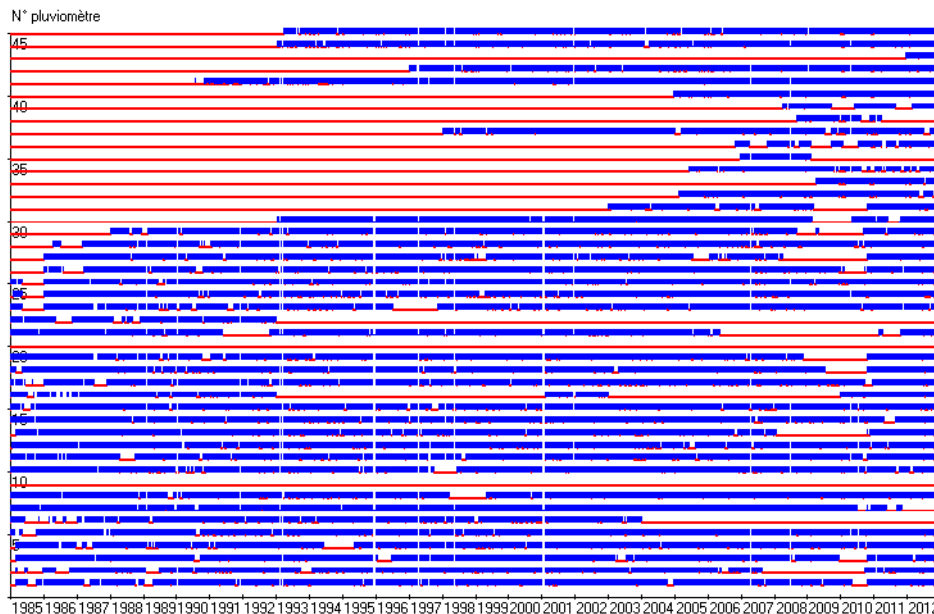
Figure C.6 – Disponibilité des données de pluie des 46 pluviomètres sur la période 1985-2012 (en rouge, les lacunes, en bleu, les données mesurées). Le pas de temps est horaire. Les pluviomètres numérotés 1 à 31 sont les pluviomètres du Grand Lyon, ceux numérotés de 32 à 39 appartiennent à Irstea et ceux numérotés de 40 à 45 appartiennent à Météo-France (données obtenues dans le cadre du projet HyMex)
