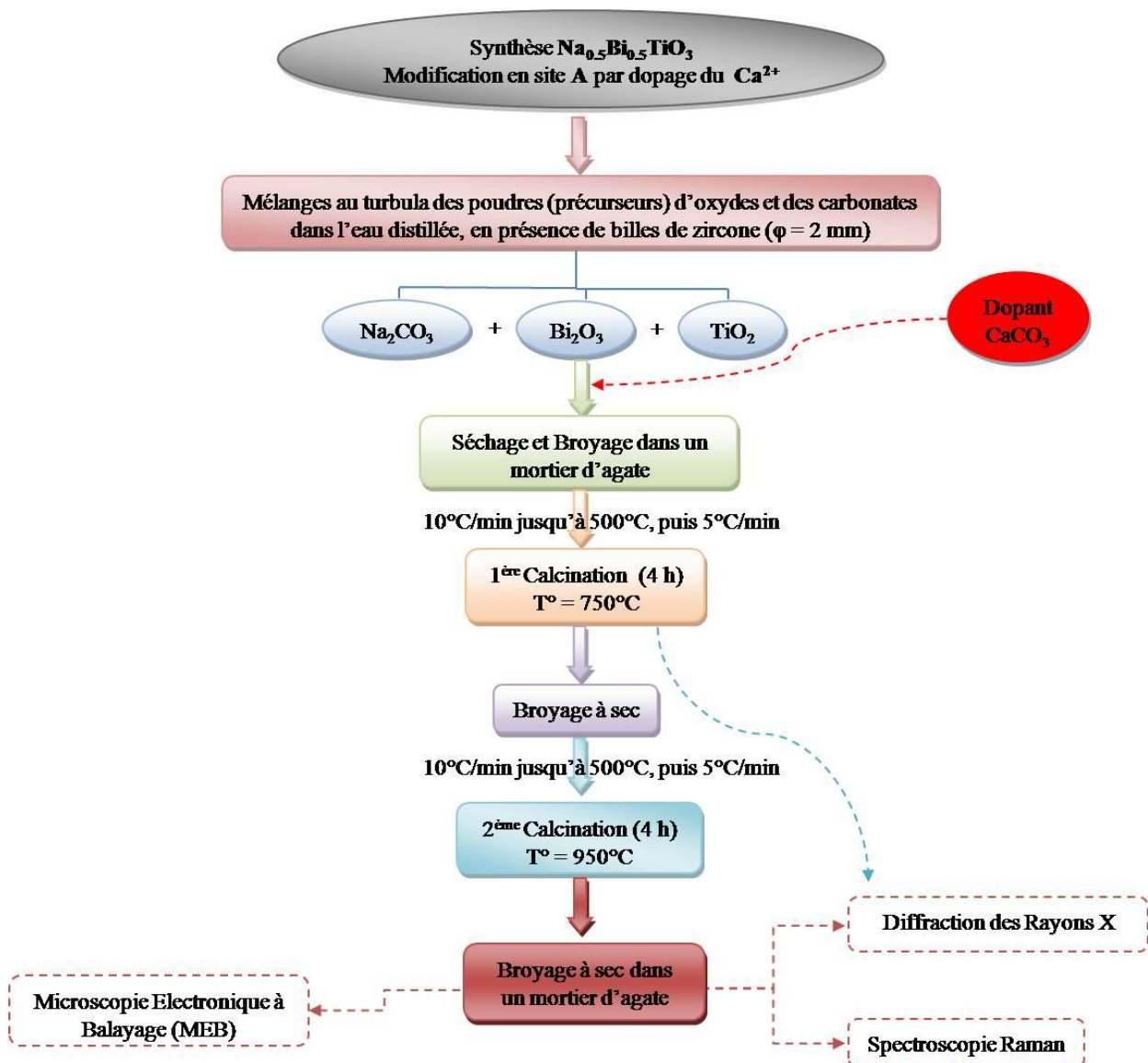
Figure II.1 : Schéma synoptique décrivant les principales étapes de synthèse des poudres par la méthode solide classique.
