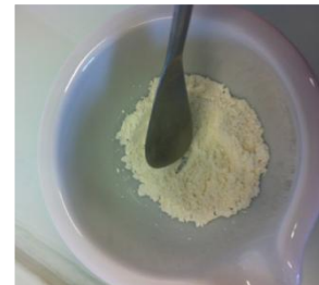
Figure II.2 : Le mélange des précurseurs obtenu après séchage dans une étuve à 100°C.
