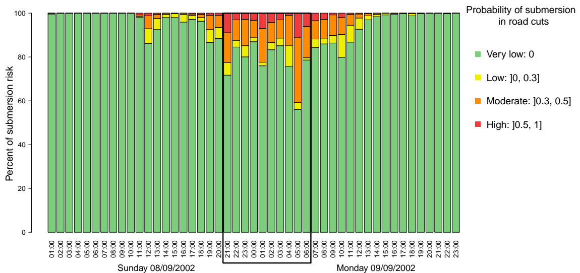
Figure V.3 Dynamique temporelle des niveaux de probabilités de submersion des points de coupure
