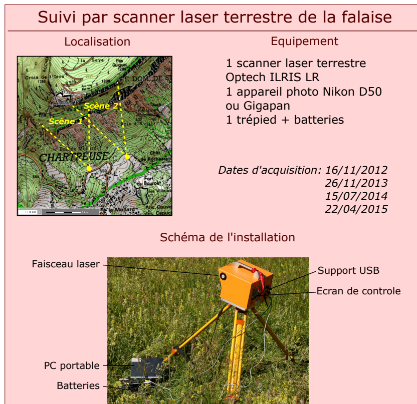
FIGURE 5.1 – Localisation et description du scanner laser terrestre utilisé pour cette étude.
