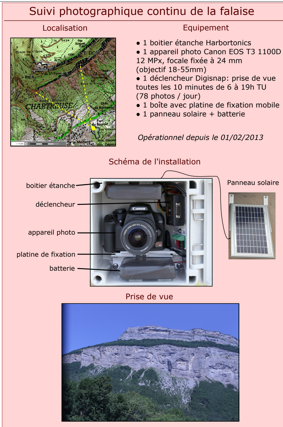
FIGURE 6.14 – Localisation et description de l'installation du suivi photographique continu de la partie Sud du Mont Saint Eynard.
