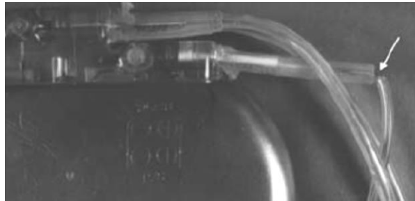
Figure 4. Exemple de rupture de sonde.
