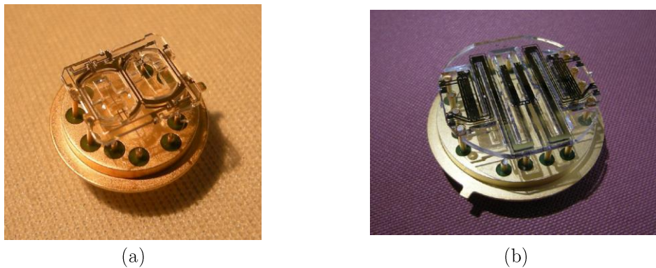
Figure 42. Accéléromètre DIVA composé de deux structures VIA montée tête bêche pour opérer une mesure différentielle (a), gyromètre VIG (b).
