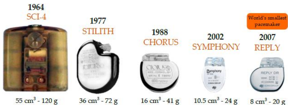
Figure 22. Evolution de la miniaturisation des stimulateurs cardiaques SORIN
