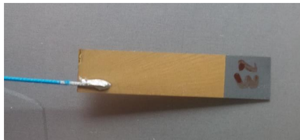
Figure 97. Prise de contact électrique sur la structure.
