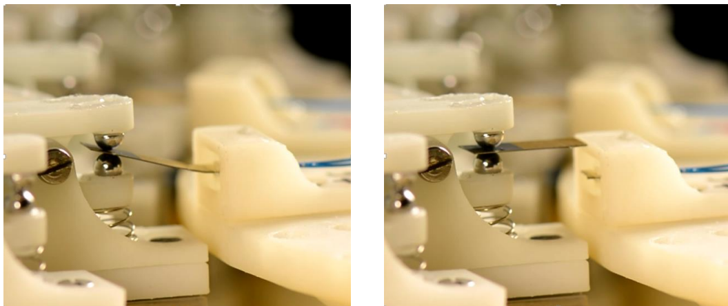
Figure 111. Test statique jusqu'à la rupture de la lame.
