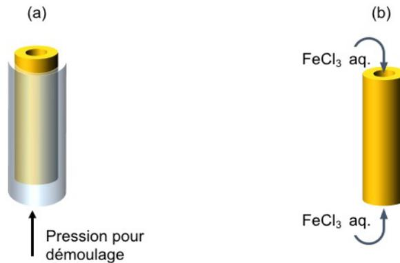
Figure 64 : Schéma représentatif d'une fibre creuse de RIP NBR/PEO (a) lors du démoulage et (b) pour insertion de la solution de FeCl<sub>3</sub> aq dans la cavité centrale pour la polymérisation de l'EDOT.
