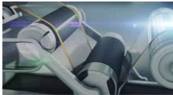
(b) Fabrication de CIGS sur substrat flexible au laboratoire NREL par procédé roll-to-roll
