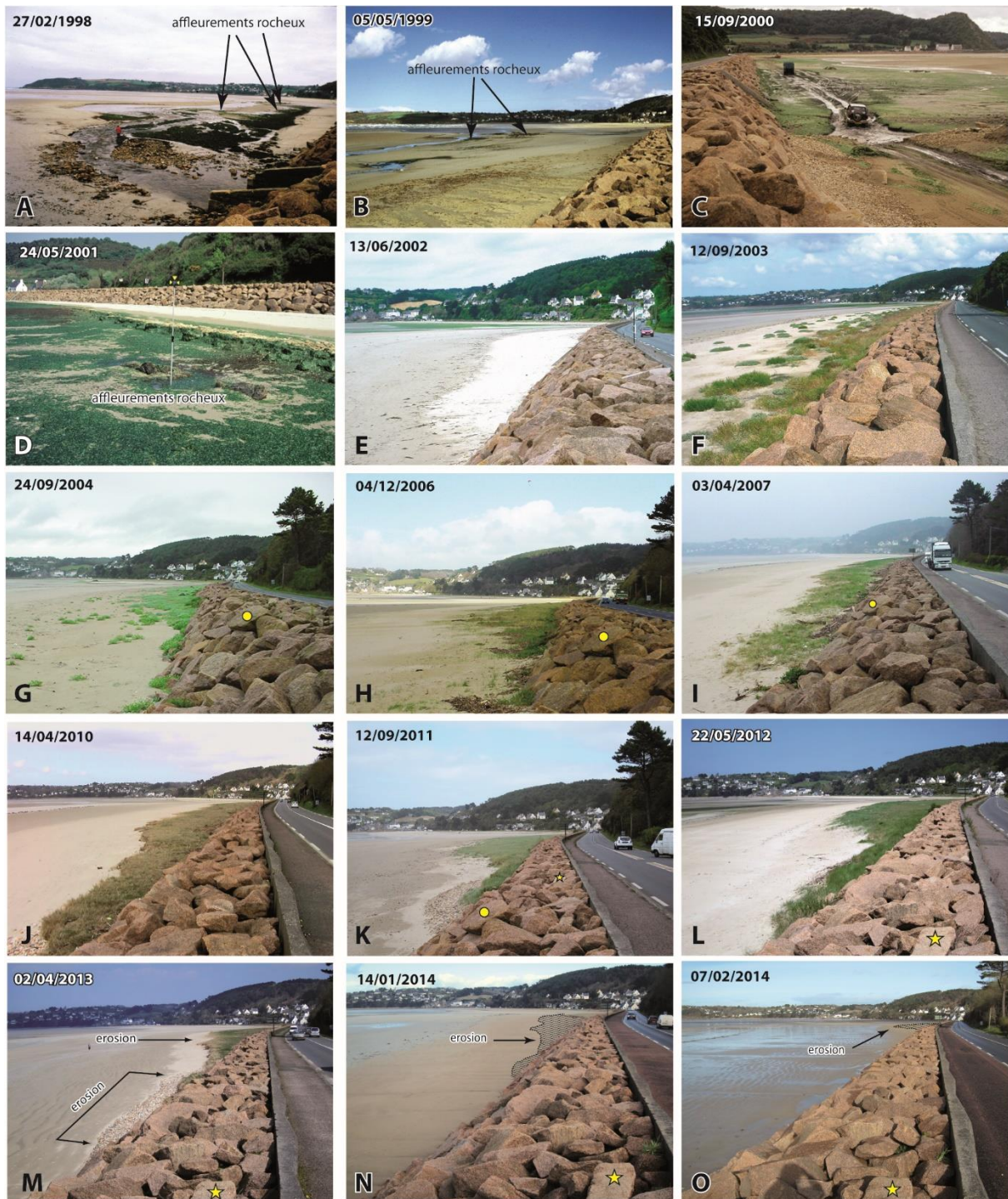
Figure 105 - Evolution du trait de côte du cordon dunaire de Tréduder entre 1998 et 2014. Entre 1998 et 2002, le cordon est inexistant (A à E) ; apparition et expansion du cordon dunaire (F à L) (l'impact de la tempête du 10 mars 2008 n'est pas visible sur les photographies) ; régénération du cordon dunaire entre 2008 et 2012 (G, H et I) ; seconde phase d'érosion à partir de 2013 (M) et quasi disparition du cordon suite aux tempêtes de l'hiver 2013-2014 (N et O).
