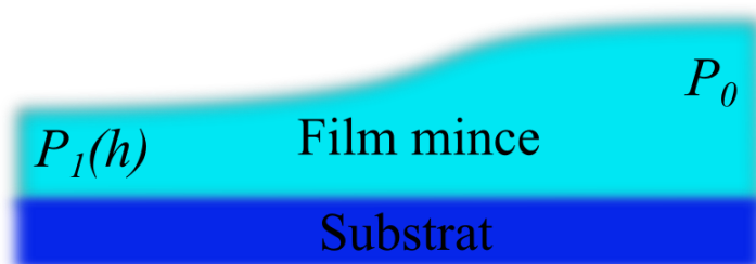
Figure 2.3 : Film mince étalé sur un substrat solide de pressions respectives, P_0 dans la partie épaisse et P_1(h) dans la partie très mince.
