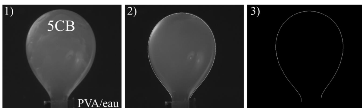
Figure 2.27 : Détection du profil réel de la goutte ascendante 5CB dans une solution se PVA.
