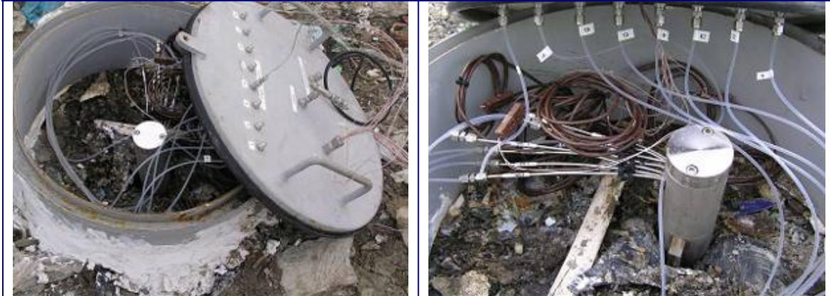
Figure 41 : Photos de la chambre positionnée au-dessus de la sonde
