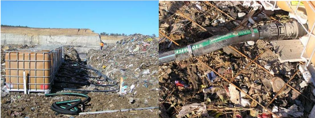
**Figure 90 : Photos des lysimètres mis en place lors de l'étude préliminaire**
