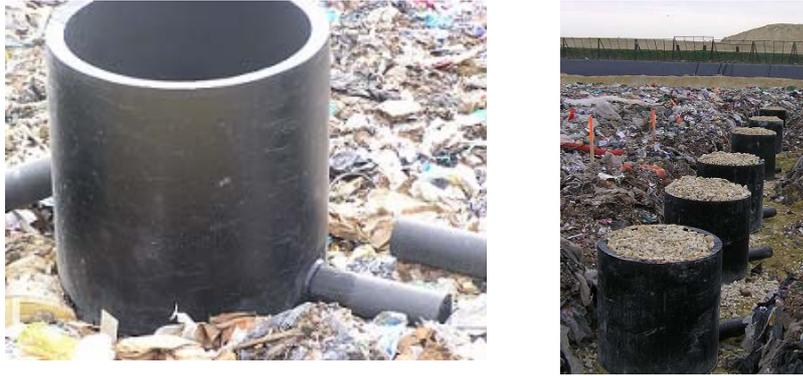
Figure 92 : Photos des lysimètres installés
