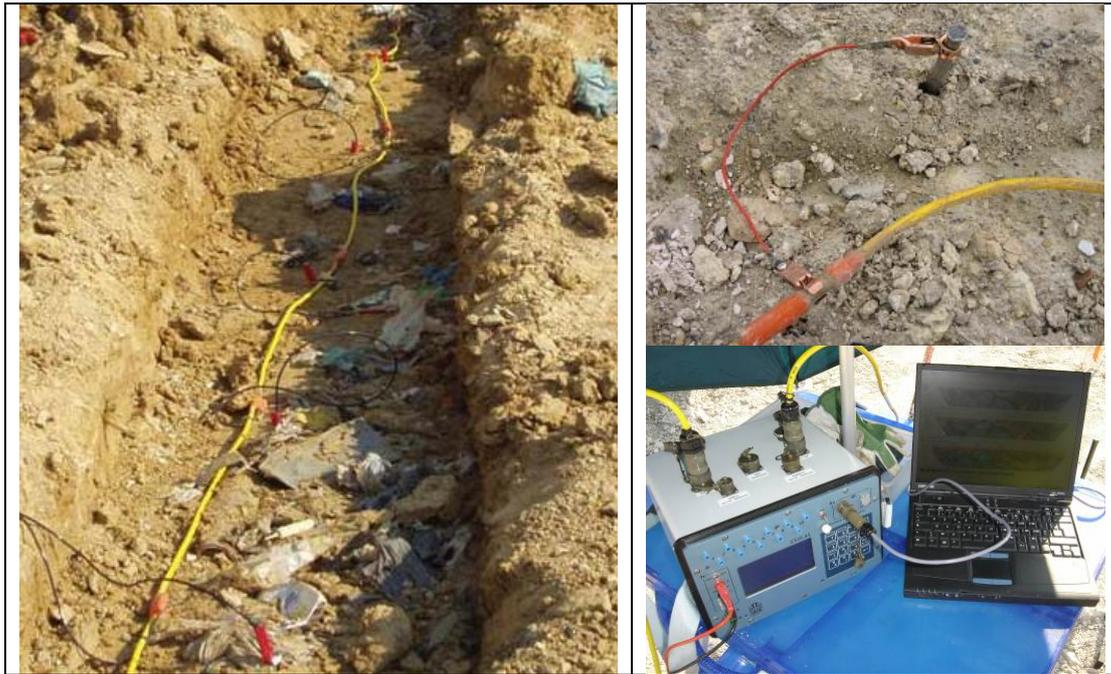
Figure 86 : Electrode géophysique et dispositif d'acquisition
