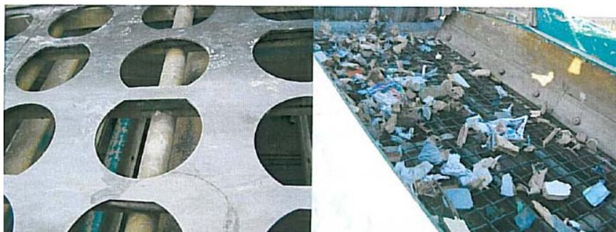
Figure 22 (a) Plaque métallique à orifices circulaires (b) Grille à mailles carrées
